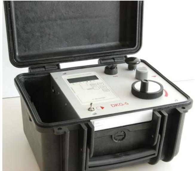
Das **Druckkalibriergerät DKG-5** ist ein Druckgenerator für die Vorgabe eines statischen Druckes mit integriertem Digitalmanometer.
